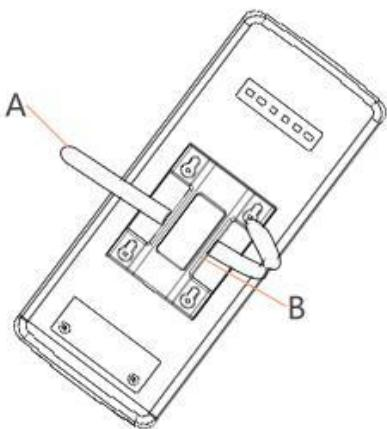
2、将主设备安装在抱杆上，用钳子将金属扎带A拉紧。
